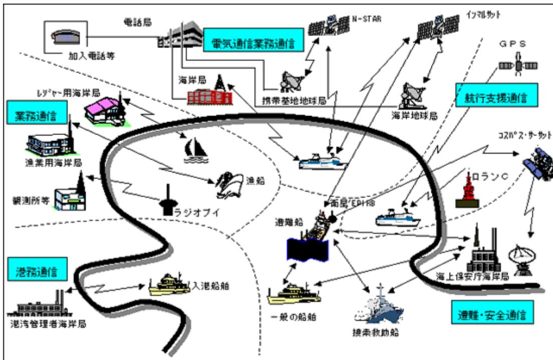
縦割り通信システム構成を表す海上通信概念図。通常の船舶間通信はなく、遭難・安全通信を除き、陸上局との通信が基準に置かれている。
